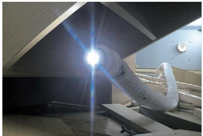
図2 瓦礫内で情報収集する索状ロボット「能動スコープカメラ」
