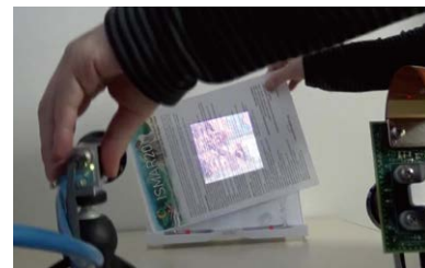
▲紙面を手で動かしてもカメラを手で動かしても、プロジェクタ映像は常に紙面上の定位位置に表示される。
